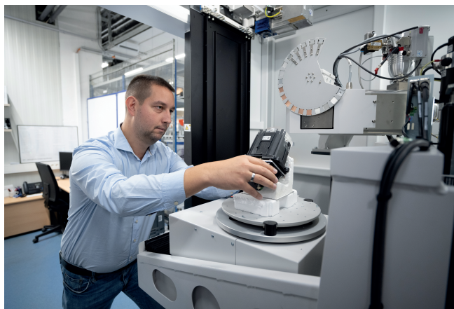
Martin Janisch spannt ein Beleuchtungsmodul in den Zeiss Metrotom 1500 im Messraum ein. © Zeiss ZKW
