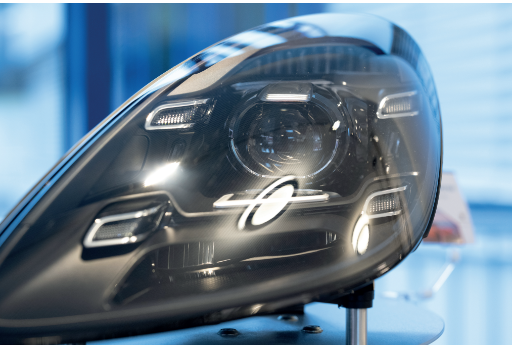
Ein moderner Scheinwerfer besteht aus bis zu 300 Einzelteilen, die hochgenau zusammengebaut und positioniert sein müssen. © Zeiss/ZKW
